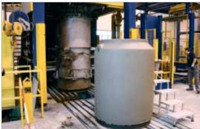
Сразу же после изготовления осуществляется распалубка шахтного элемента.
