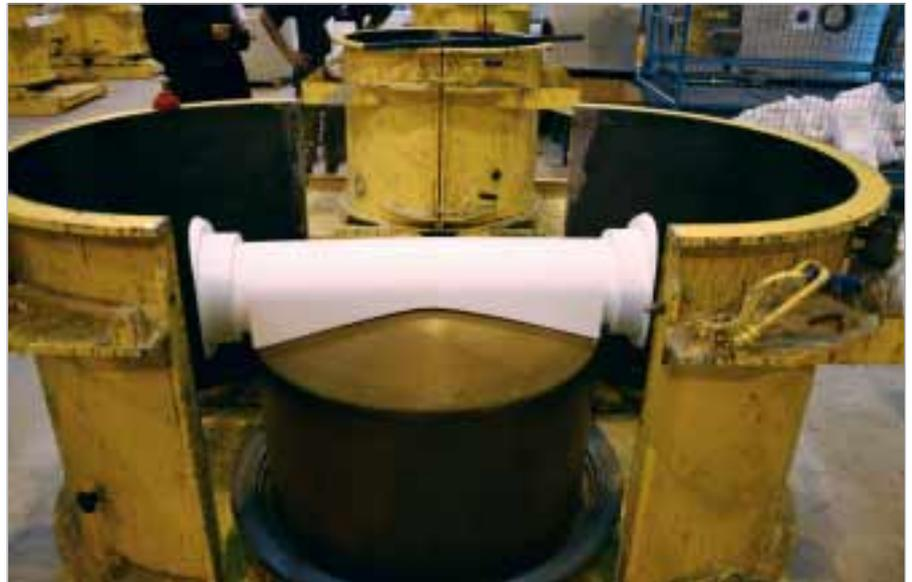
*При подготовке к производству колец с днищем - для создания единого вкладыша - заготовки из стиропора режутся посредством горячей проволоки, что делает возможным отличное прилегание всех изогнутых элементов друг к другу.*
